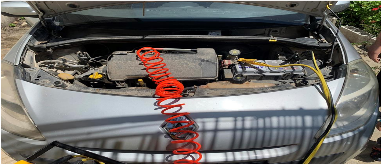
Figure IV.3 : Connexion de l'équipement de décalaminage à la conduite d'admission.
