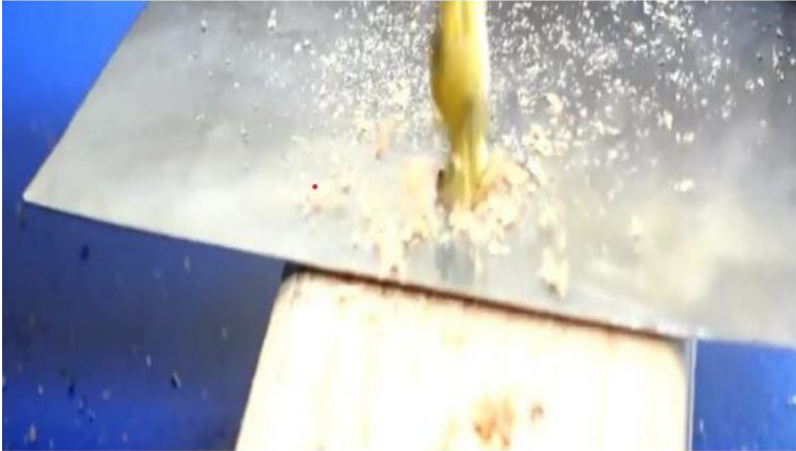
Figure III.5 : perçage des plaques inox.
