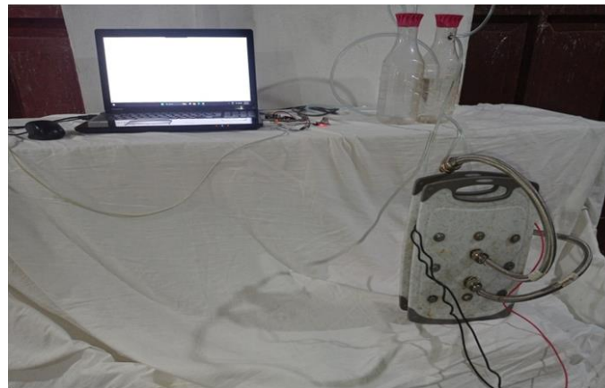
Figure IV.10 : Connexion de l'électrolyseur avec l'Ordinateur et l'Arduino.
