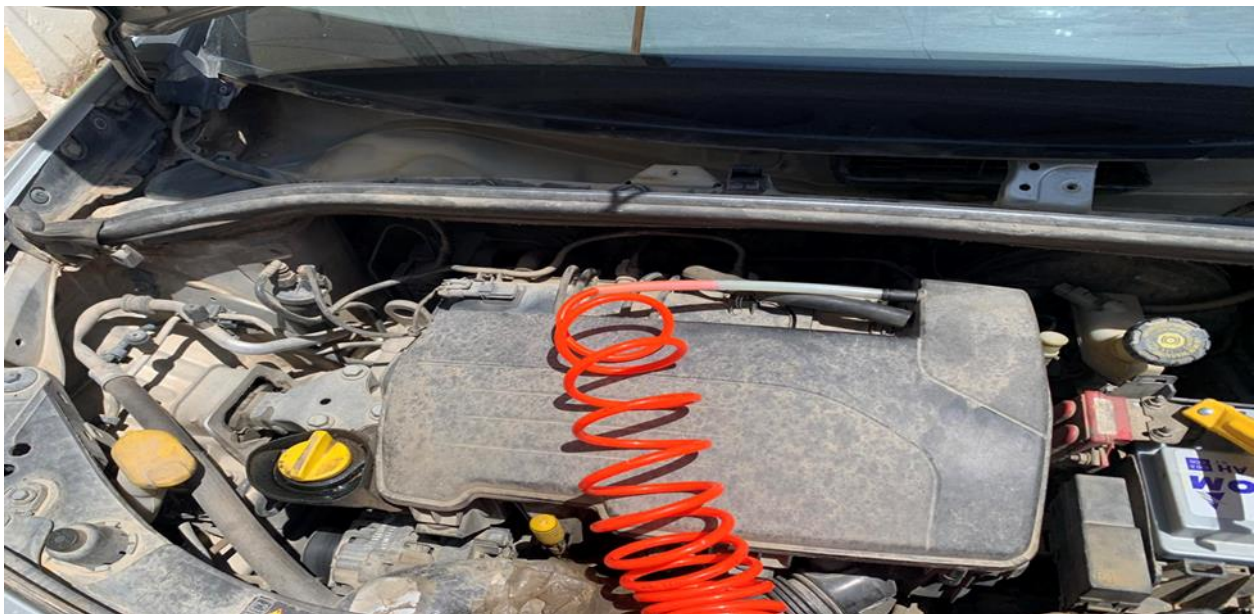
Figure IV.2 : Point d'injection d'hydrogène dans le système d'admission d'air du moteur.
