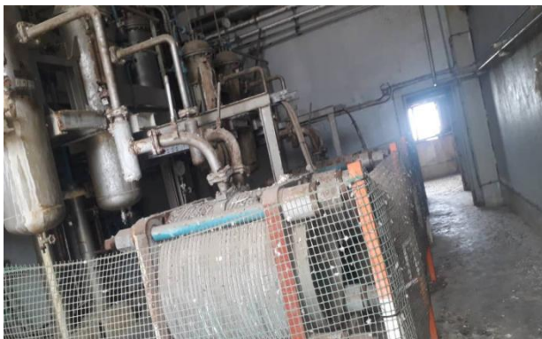
Figure II.2 : Électrolyseur de type filtre-presse.
