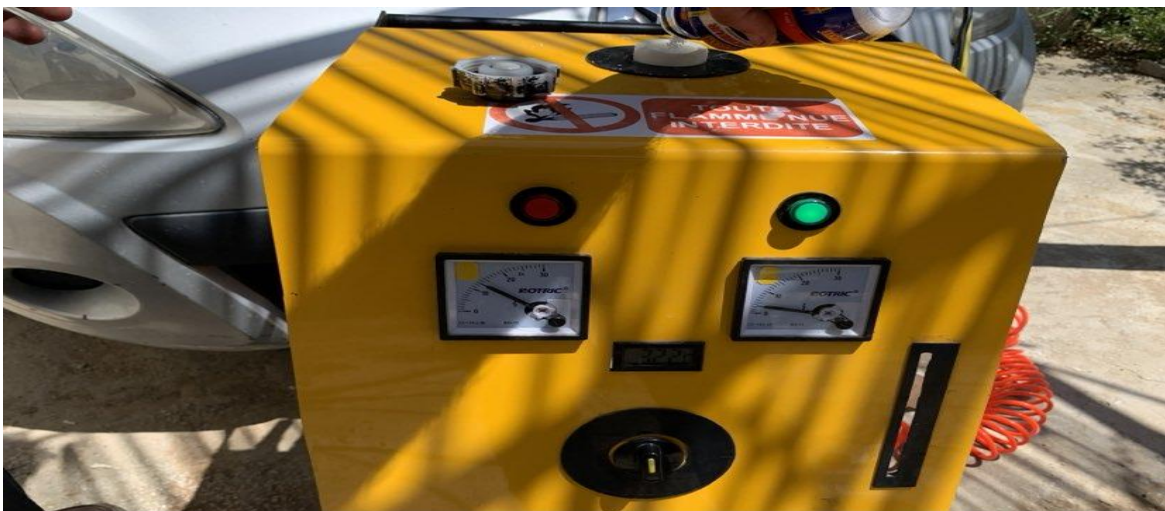
Figure IV.4 : Réglage de l'appareil de décalaminage.
