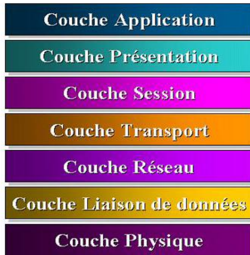
Figure I.6 : Les sept couches du modèle OSI [9].
