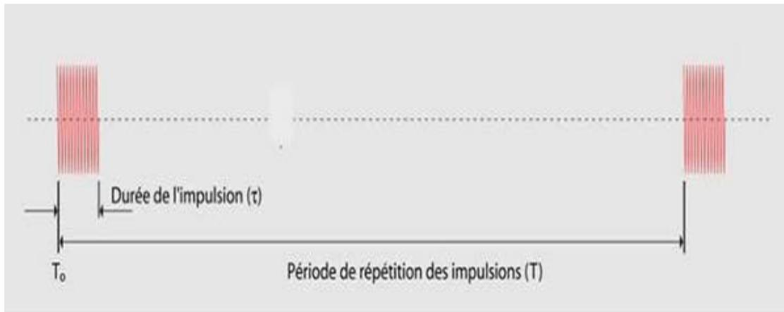
Figure1.3 : Signal émis par un radar impulsionnel.
