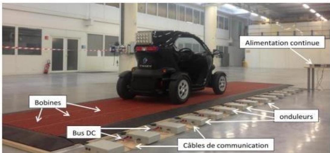
**Figure I.13 Système DWPT développé par Renault-Supelec, source [16]**
