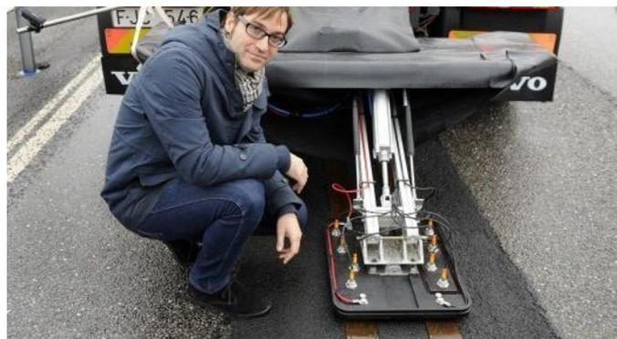
**Figure I.11 Un système de charge dynamique pour recharger les véhicules électrique**
