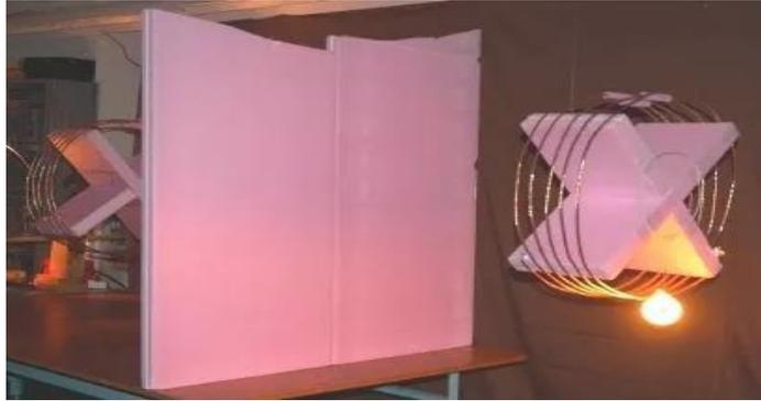
**Figure I.1** Démonstration de système d'alimentation sans fil en allumant une ampoule située à deux mètres d'une source d'énergie
