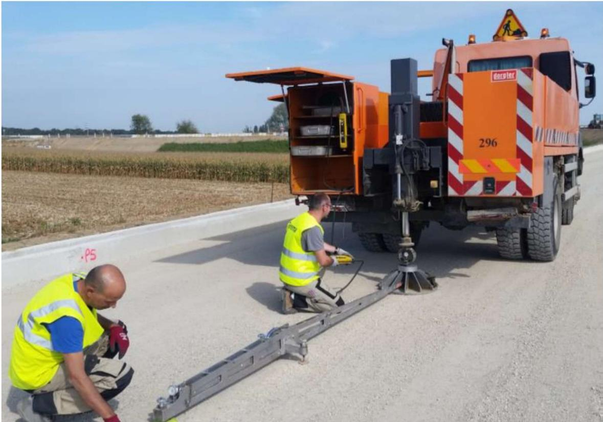
Figure 3.8 poutre de Benkelman
