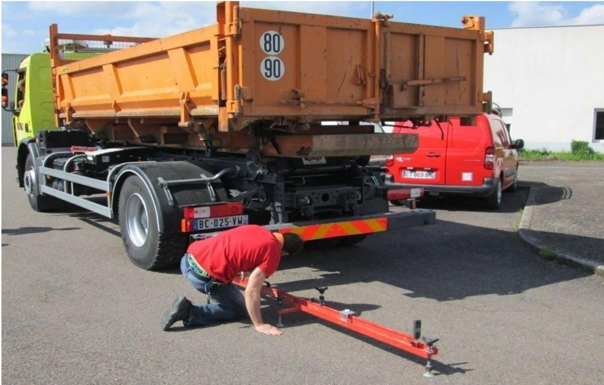
Figure 3.24. La mesure de la déflexion à la poutre Benkelman.
