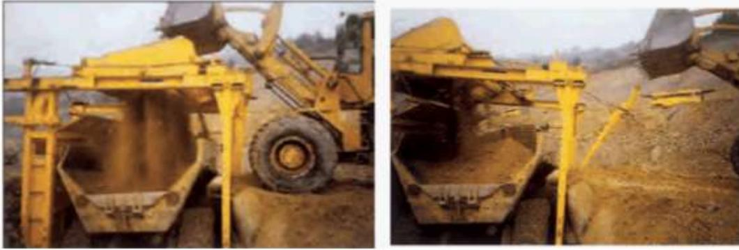
Figure 2.10 : Ejection des éléments grossiers par basculement de la grille.
