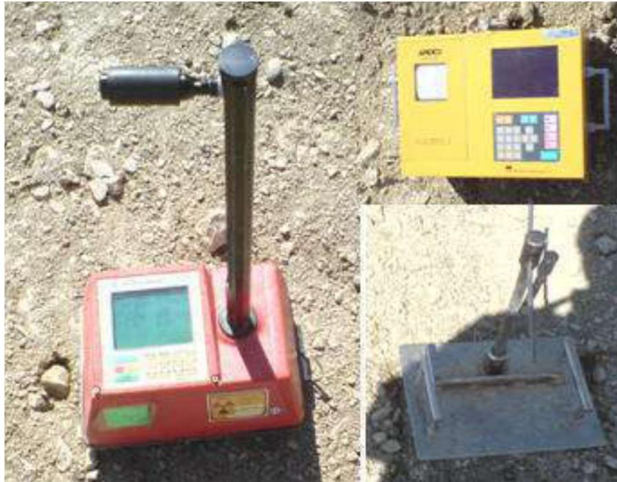
Figure. 3.5 : Matériels d'essai Gammadensimètre
