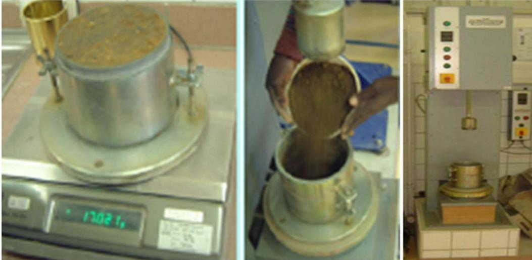
Figure. 3.1 : Matériels d'essai Proctor
