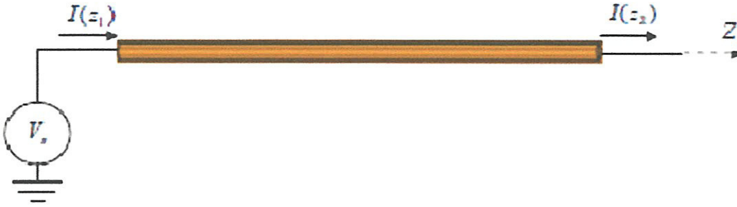
Figure II.14. Ligne monophasé parcourue par un courant harmonique.
