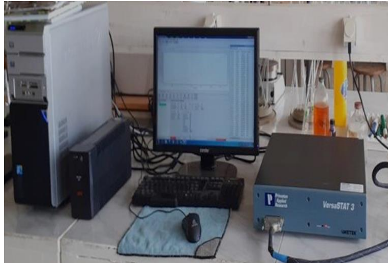
Figure 20. Chaîne de corrosion utilisée pour les tests électrochimiques.
