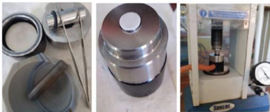
Figure 15. Préparation des pastilles à base de KBr.
