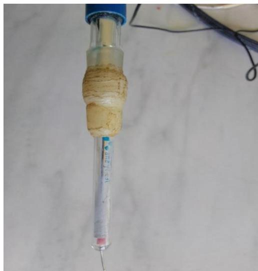
Figure II.4. Contre électrode
