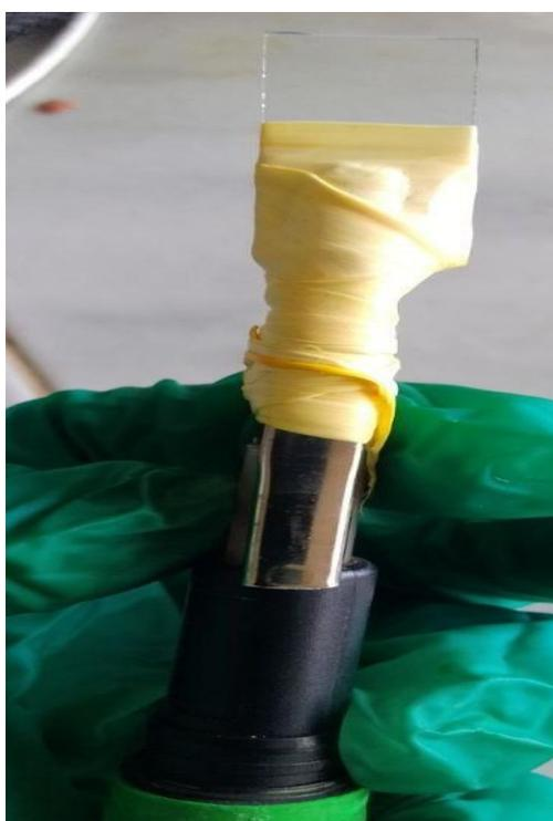
Figure II.3. Electrode de travail à base d'ITO
