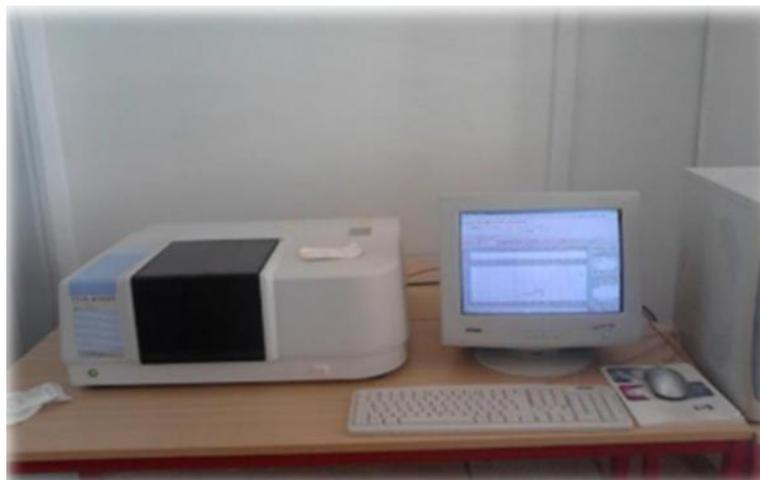
Figure II.11. Image de Spectroscopie Infrarouge à Transformée de Fourier (FTIR)
