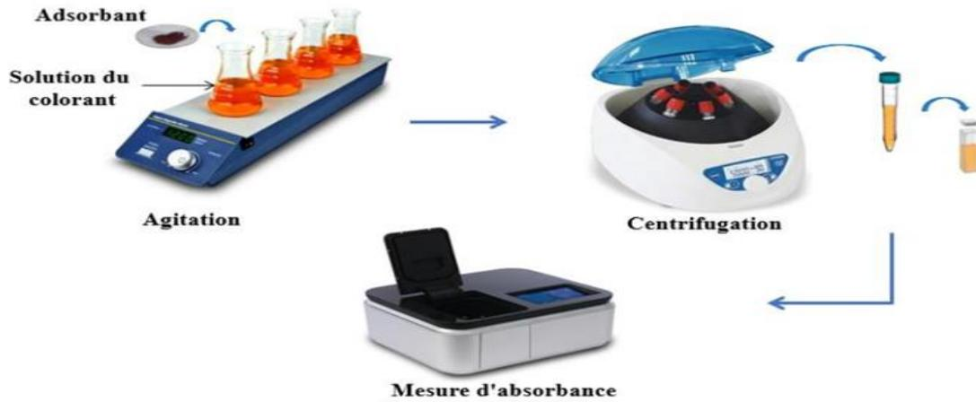
**Figure II.7** Représentation schématique des expériences d'adsorption [8].
