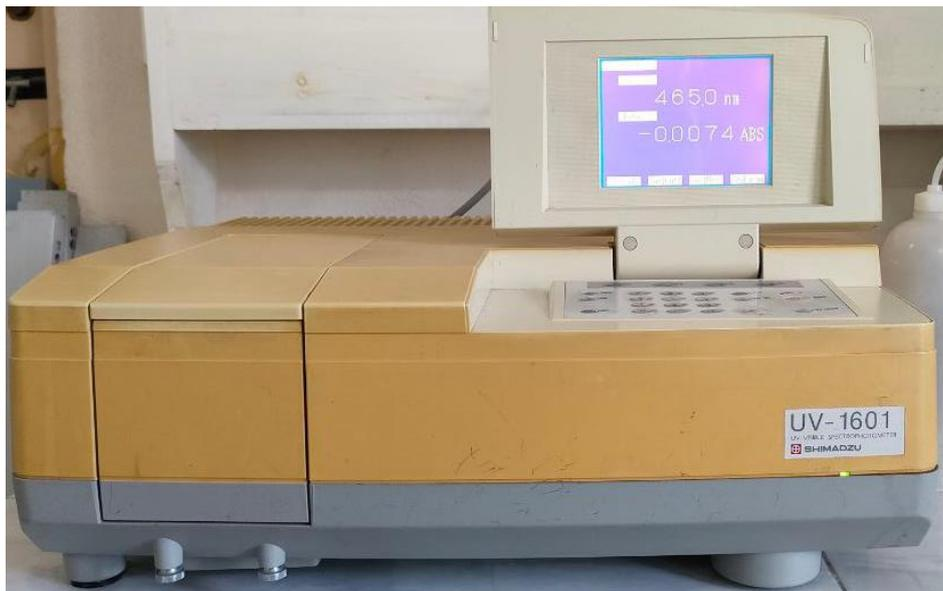
**Figure II.2** Photo numérique du spectrophotomètre UV-visible utilisé.
