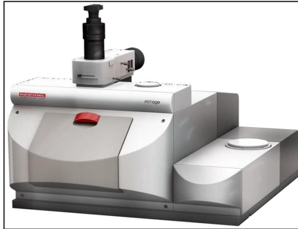
Figure 22 : Spectroscopie Infrarouge à Transformée Fourier (FTIR).
