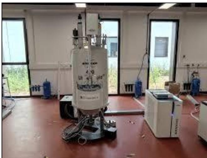
**Figure 26 : Spectromètre RMN.**
