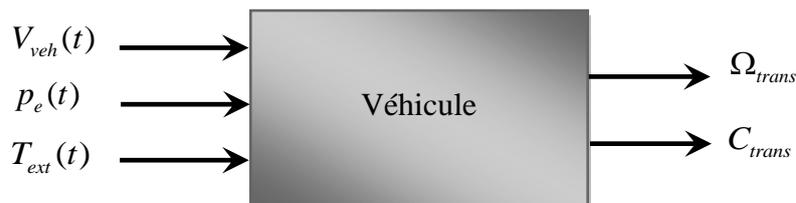
Fig II.6: Représentation simplifié du modèle véhicule.
