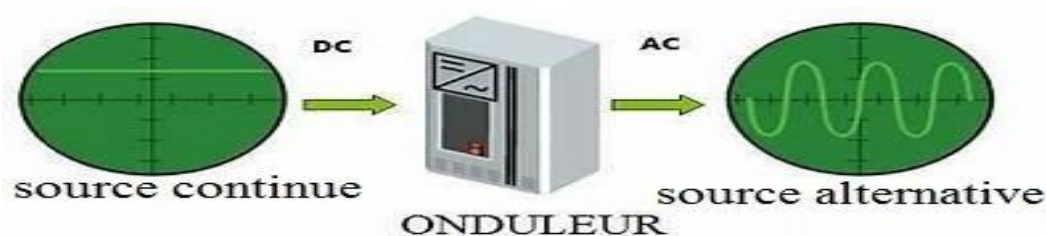
Figure I.1 : Schéma de principe de la conversion continu-Alternative (DC-AC).
