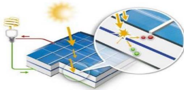
Figure II.2 : Principe de fonctionnement de la cellule PV [16].
