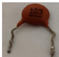
Figure I.6. Condensateur céramique 10nf.
