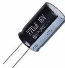
Figure I.8. Condensateurs électrolytiques aluminium 22 \mu F 16V.
