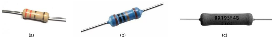
Figure I.2. Différents types des résistances fixe : (a) Résistance au carbone (b) Résistance métallique non-bobinée (c) Résistances métallique bobinée.
