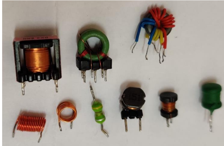
Figure I.12. Différents types d'inductances.
