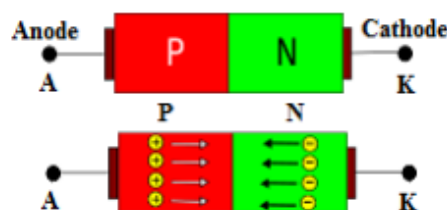
Figure I.17. La jonction PN
