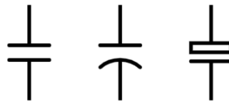
Figure I.5. Symboles normalisés d'un condensateur.
