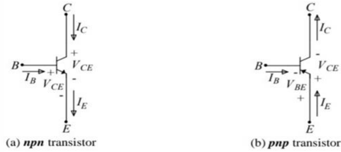
Figure I.26. Symbole électrique d'un transistor bipolaire : (a) transistor NPN, (b) transistor PNP
