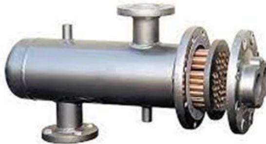
**Figure I. 8.** Echangeur de chaleur à faisceaux tubulaires
