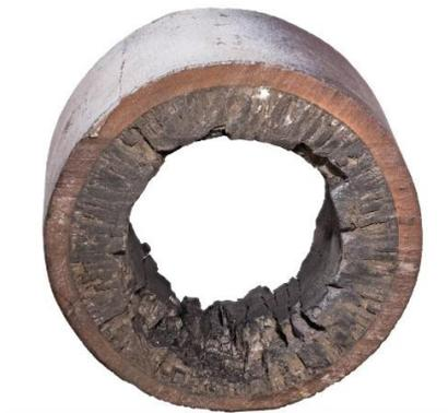
**Figure I. 12.** Coupe d'un tube d'échangeur colmaté
