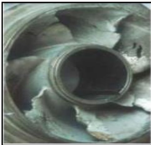
Figure I. 7 : Une érosion par cavitation d'une roue de pompe centrifuge [10]
