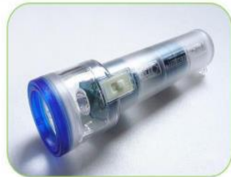
Fig.I.17. Lampe torche utilisant la conversion électromagnétique [16]
