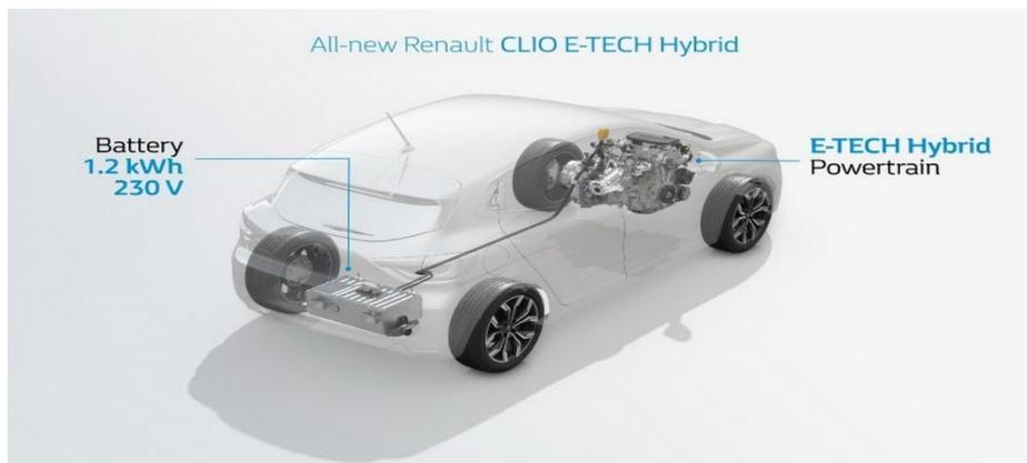
Figure II.10. Nouvelle Renault CLIO E-TECH Hybrid « full hybrid ».
