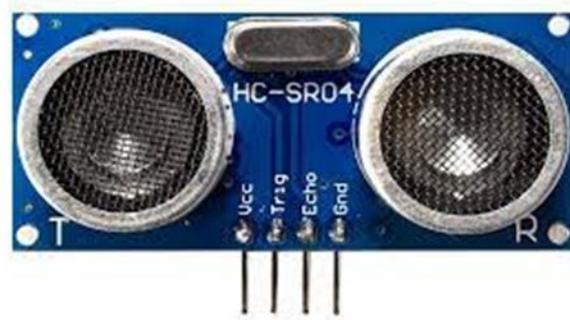
Figure IV. 7. Capteur ultrason HC-SR04.
