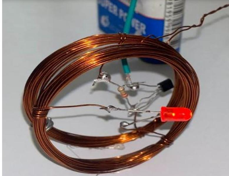
Figure IV. 18. Deux bobines utilisées pour le TEF, avec la LED allumée, indiquant un transfert d'énergie réussi.
