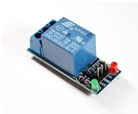
Figure IV. 10. Relais électrique SRD-05VDC-SL-C.
