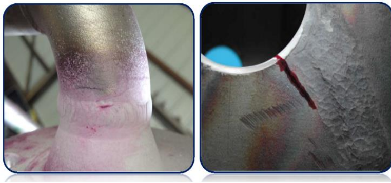
Figure I.8: Révélation de fissures par ressuage [2]
