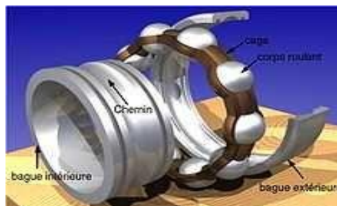
Figure II.6. Roulement à billes éclaté
