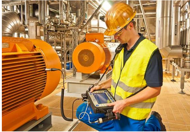
Figure I.12. Principe de l'analyse vibratoire
