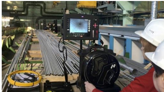
Figure I.2. Exemple de contrôle visuel
