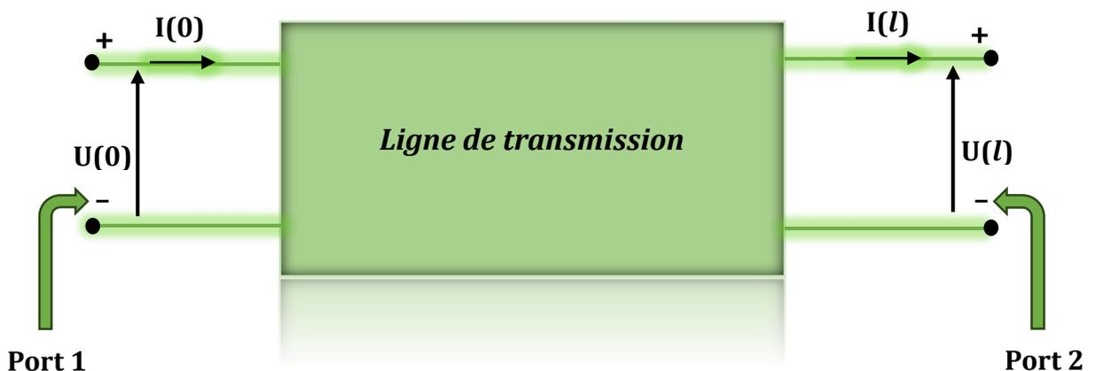
Figure II.2. Représentation quadripolaire d'une ligne bifilaire.
