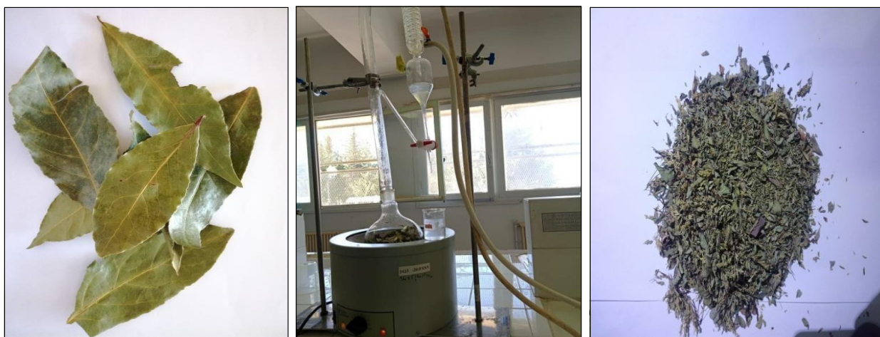
Figure 12. Extraction des huiles essentielles de Lauris nobilis et de Thymus vulgaris par hydrodistillation (Appareil de type Clevenger).
