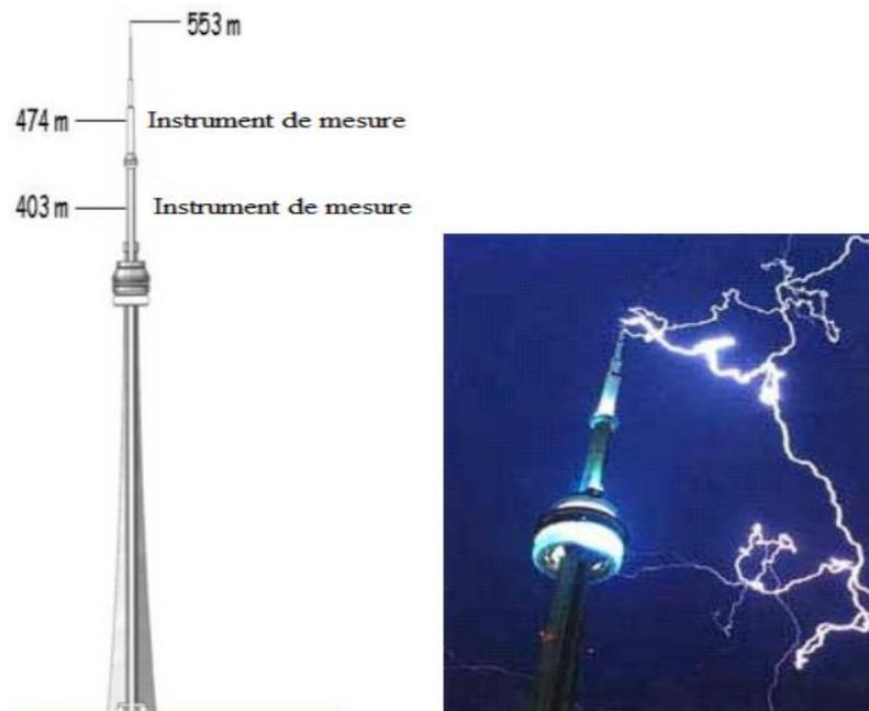
**Figure I.14.** Mesure de courant de foudre en utilisant une tour instrumentée. Tour CN à Toronto au Canada [I.13].
