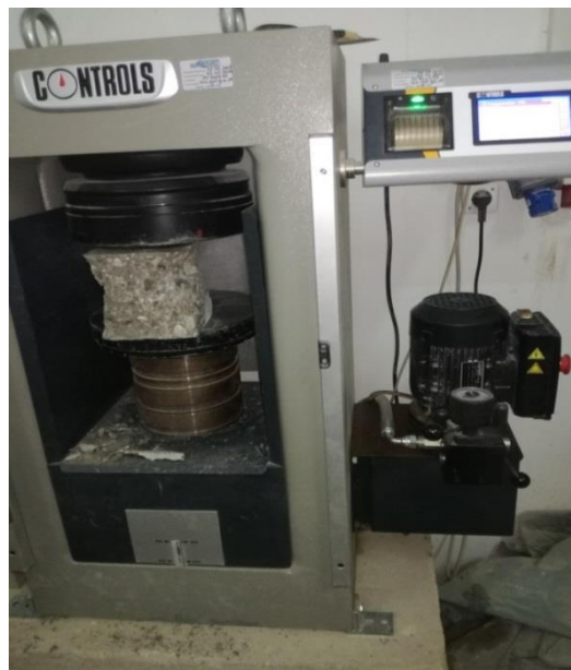
Figure III.2: Essai de résistance à la compression (laboratoire de RIZZANI DE ECCHER).
