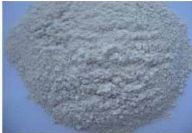
Figure I.5 : Cendres volantes : une poudre ressemblant au ciment.
