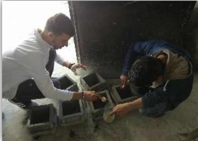
Figure II.10: Préparation des moules avant le remplissage.
