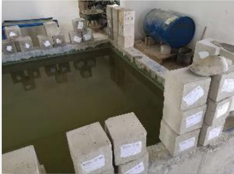
Figure II.11 : Conservation des éprouvettes.
