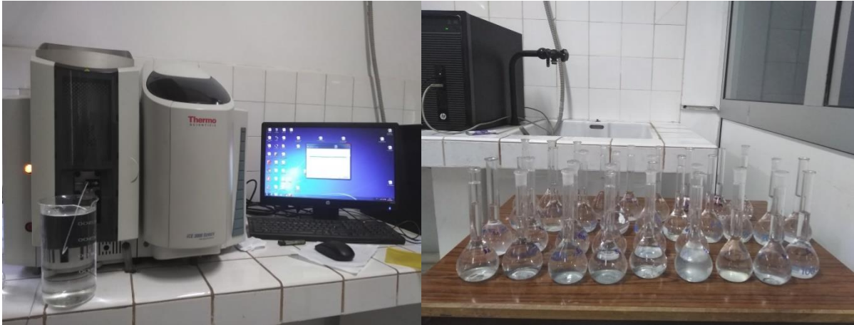
Figure 23 : Analyse d'ETM sur les roches par la SAA au laboratoire de ressources minérales à l'université El Manar de Tunis.
