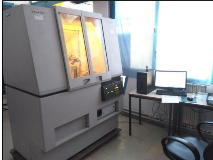
Figure 22 : Diffractomètre à rayons X (PANalyticalX'Pert PRO) au laboratoire de ressources minérales à l'université El Manar de Tunis.
