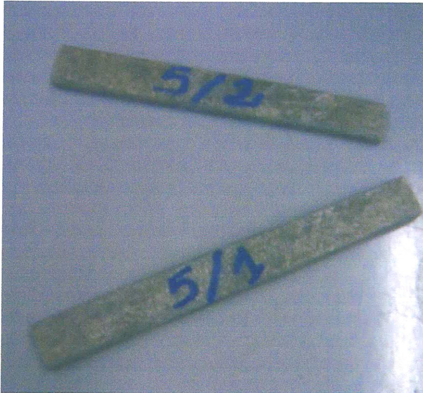
Figure III.3b : Exemples d'éprouvettes de flexion réalisées
