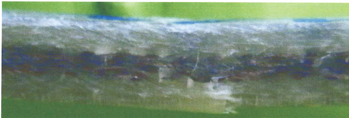
Figure IV.A.2: Fissuration de la face tendue de composite A en flexion 3 points :
