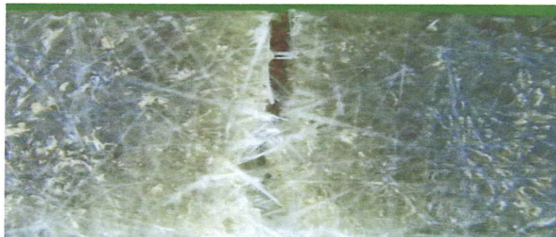
Figure IV.B.4 : Rupture transversale de la matrice et renforts dans le composite B : [2M/\pm 45]_{sy}
