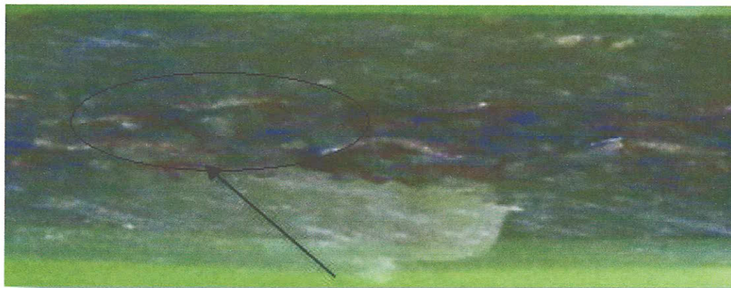
Figure IV. C.2: Délaminage et fissuration de composite C en flexion 3 points : [2M/\pm 60]_{sy}
