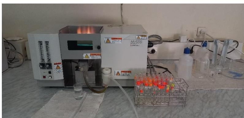
Figure 11 : Spectrophotomètre d’absorption atomique à flamme.
