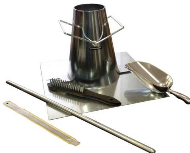
Figure IV.10. équipement nécessaire de l'affaissement.
