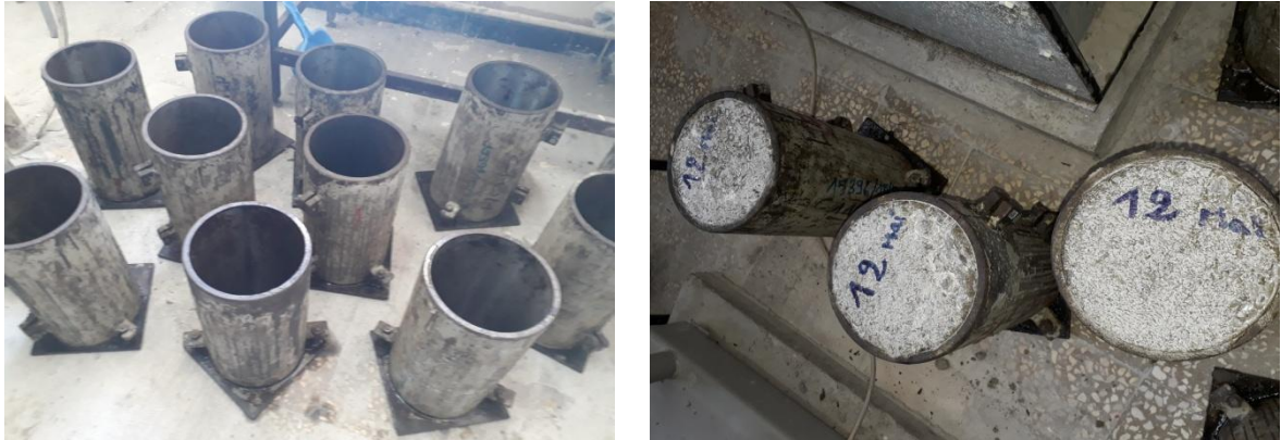
Figure IV.8. Confection des éprouvettes pour l'essai de compression.
