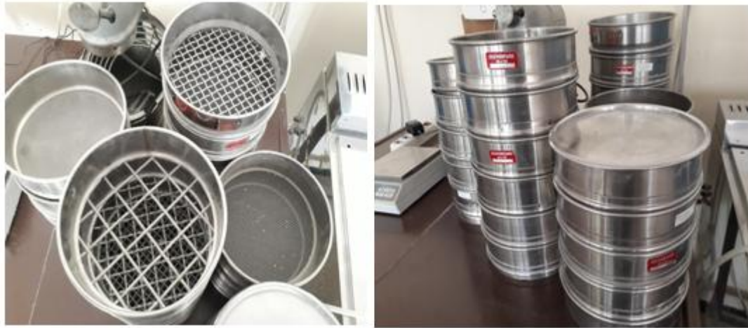
Figure IV.1. colonne des tamis.
