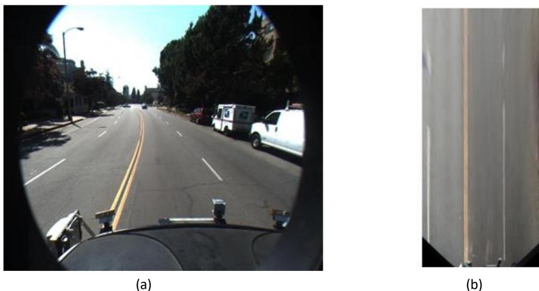
**Figure 2.5 :** Mappage de perspective inverse (IPM) : image originale (a), image vue à vue d'oiseau par IPM(b).
