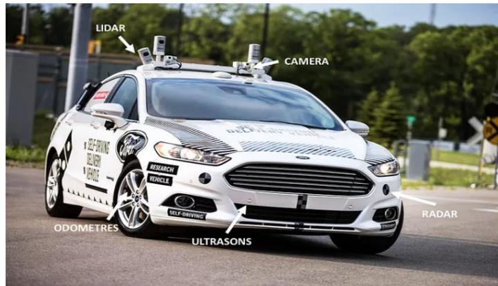
**Figure 1.3 :** Différents capteurs sur une voiture autonome.
