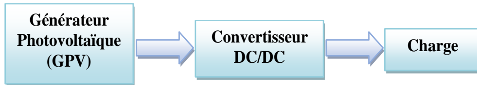
Figure I.7 – Chaîne photovoltaïque autonome
