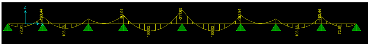
Fig.VI.7. Schéma des sollicitations (ELS) Sens XX.
