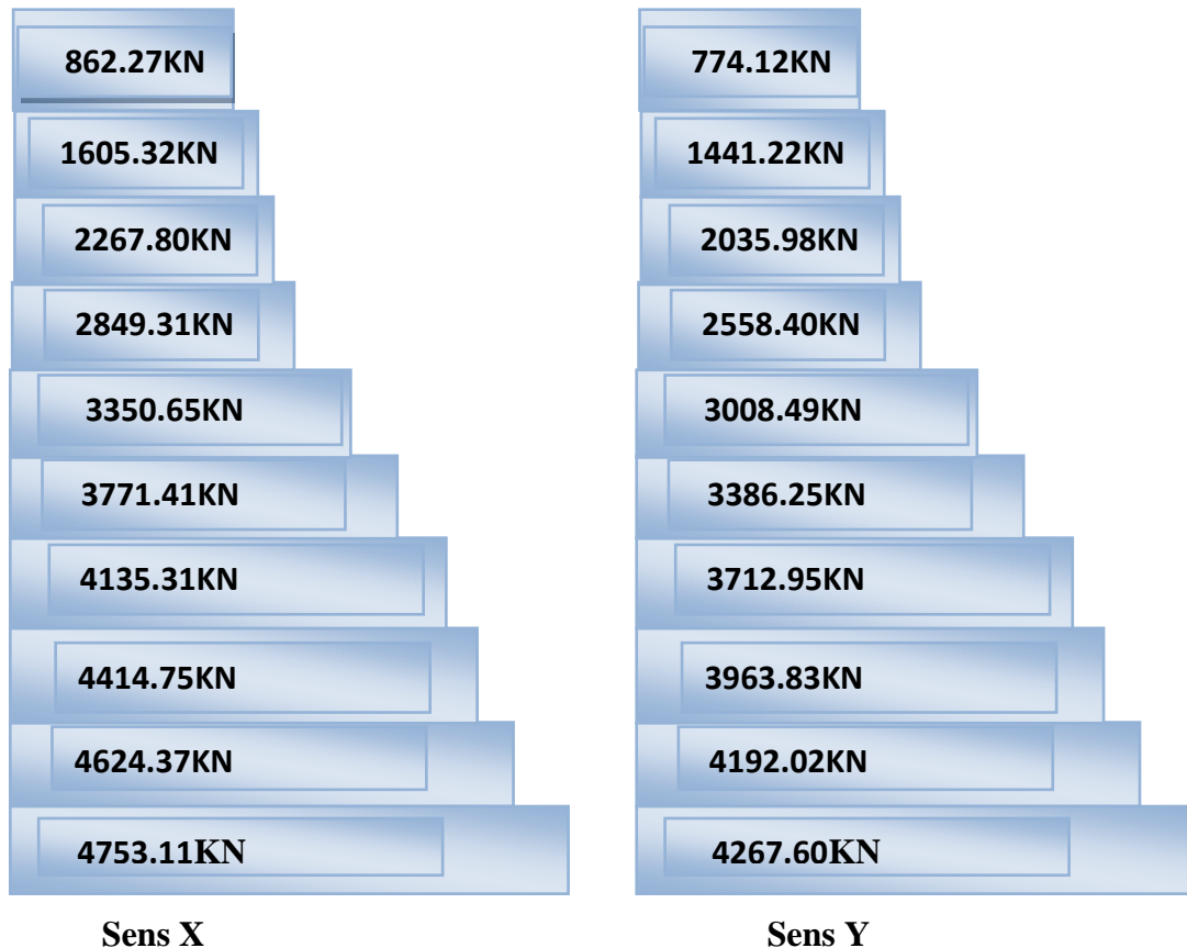
Figure. V.7 Distribution de l'effort tranchant selon la hauteur.
