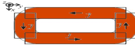
Fig.III.13 Subdivision de bobine en quatre conducteurs massifs
