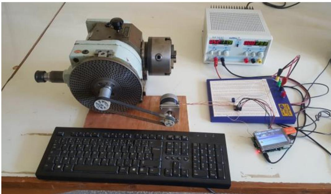
**Figure III.20:** Montage complet du diviseur électromécanique réalisé dans ce projet.
