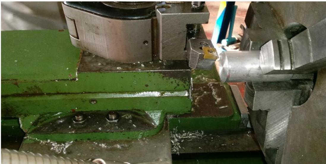
**Figure III.18:** Capture au cours de l'usinage de la pièce d'adaptation de la petite poulie crantée ( $z_1 = 35$  dents).
