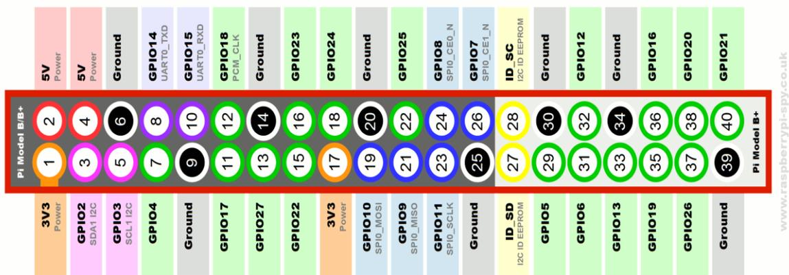
Figure III.2: Pins du Raspberry Pi3.
