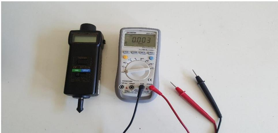
**Figure III.13:** Appareils de mesure : tachymètre et multimètre.
