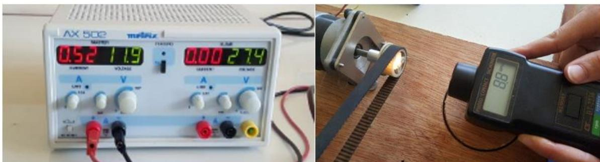
**Figure III.14:** Réglage de la tension d'alimentation à  $12\text{ v}$  et mesure de la de rotation du moteur par tachymètre.
