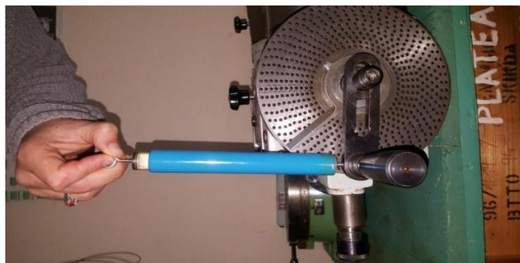
**Figure III.12:** Mesure de la force minimale pour tourner le diviseur par dynamomètre.
