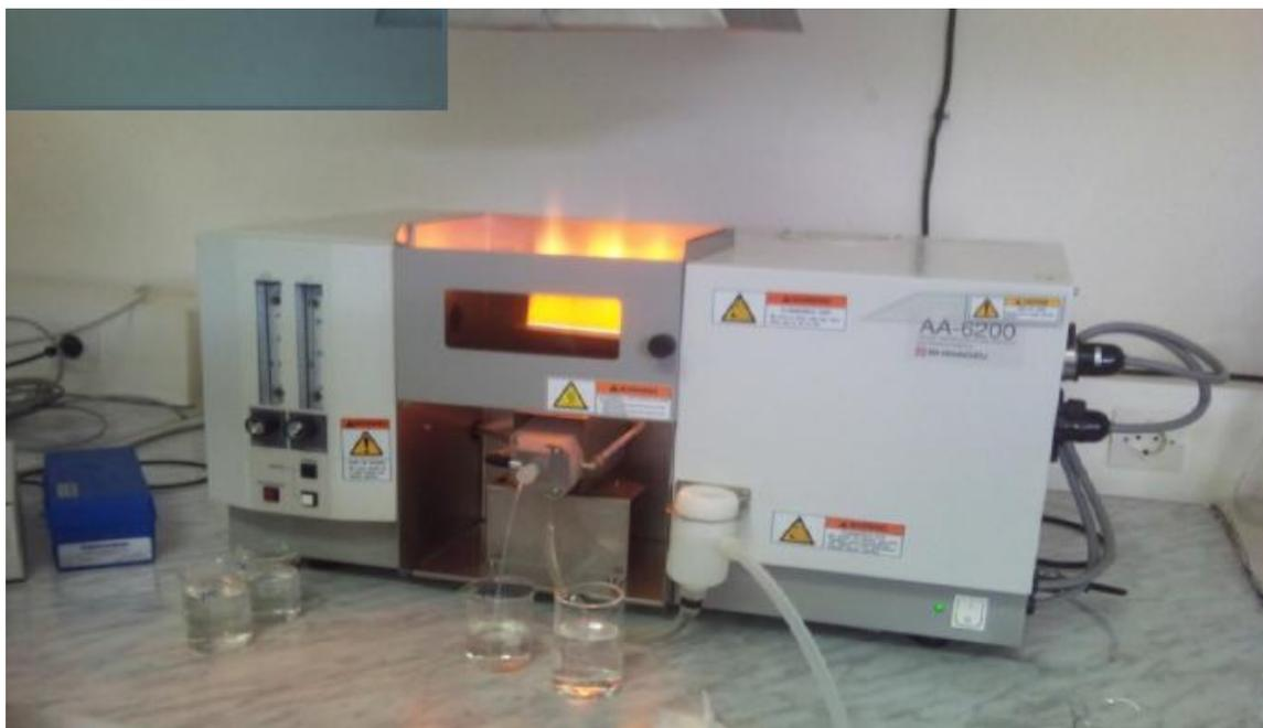
**Figure 8 :** spectrophotomètre d'absorption atomique (AA-6200).
