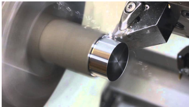
Fig. I.9 : tournage de l'acier (forme cylindrique)
