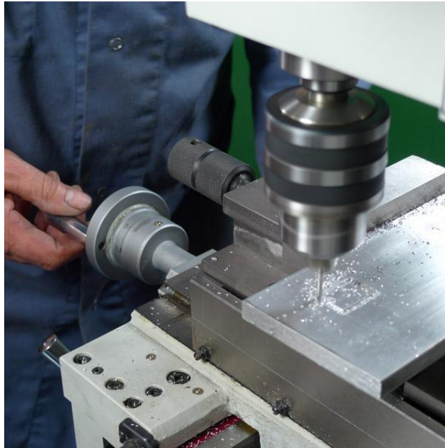
Fig. I.10 : fraisage d'une pièce (graveure sur métal)
