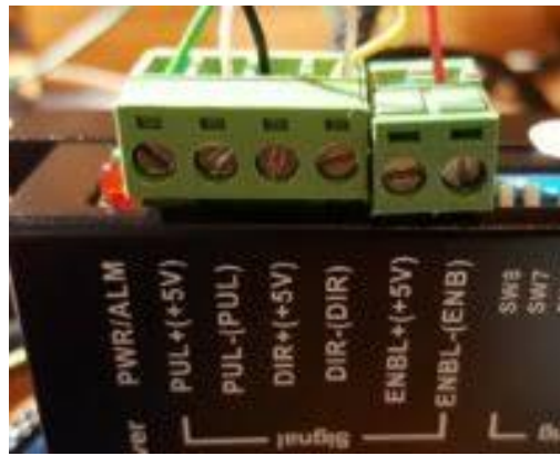
Fig. III.9 : connexion signal de commande avec la carte arduino.
