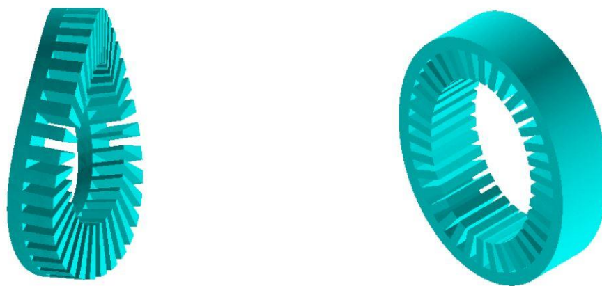
Figure I -10 Vue schématique des stators : à flux radial à axial et à flux radial à droite
