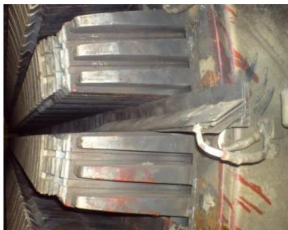
Figure I.4. Encoches du turboalternateur
