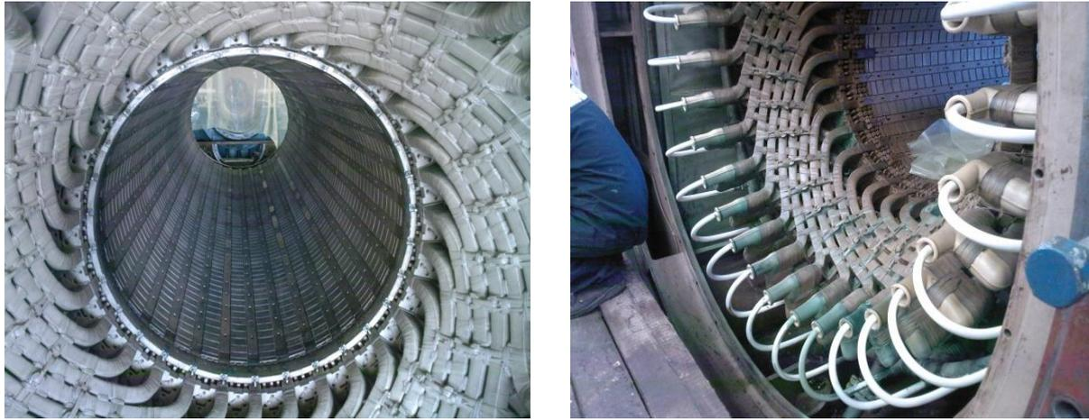
Figure I.2. Stator du turbo-alternateur.
