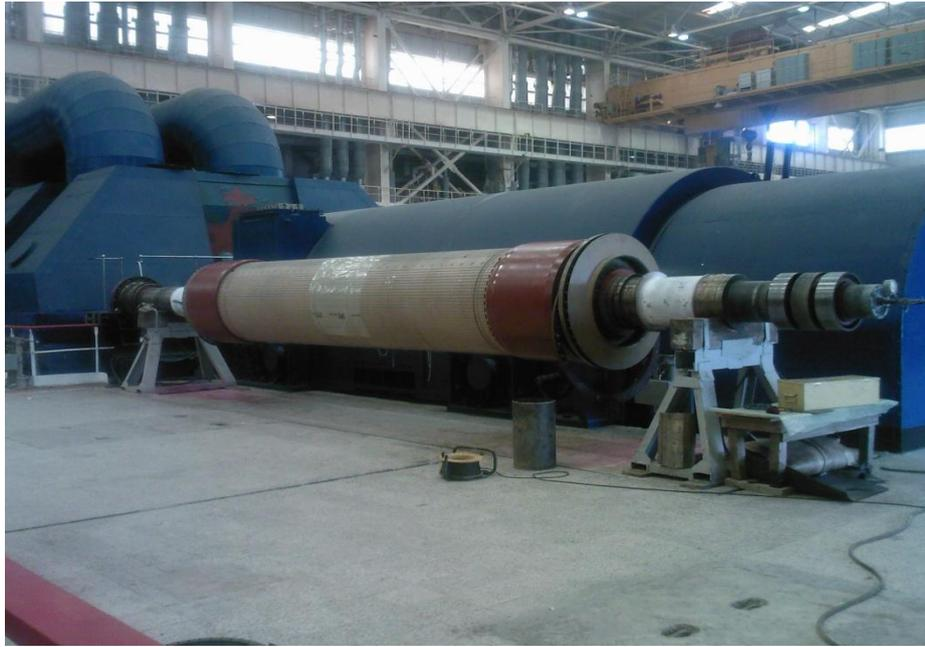
Figure I.5. Rotor du turbo-alternateur.
