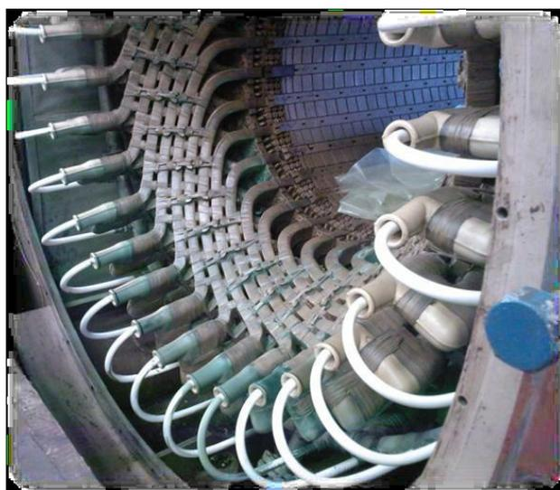
Figure II.14. Connexions hydrauliques de l'enroulement stator.
