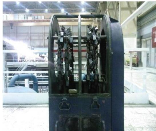
Figure I.10. Dispositif porte balais.
