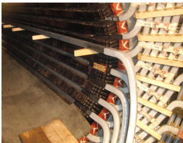
Figure I.3. Enroulement du turboalternateur
