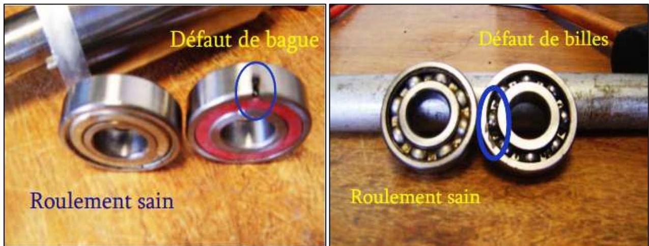
*Figure 1.9. Roulements sains et défectueux*
