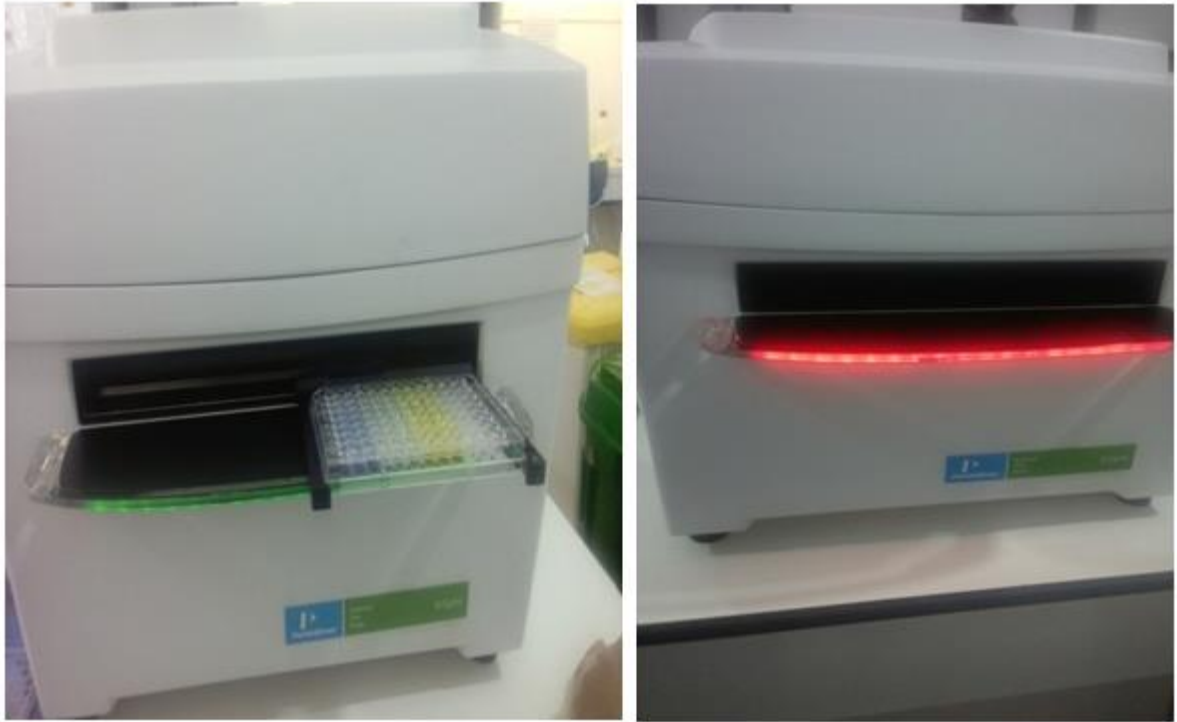
Figure 03 : Lecteur de microplaque Perkin Elmer utilisé pour le dosage spectrophotométrique.
