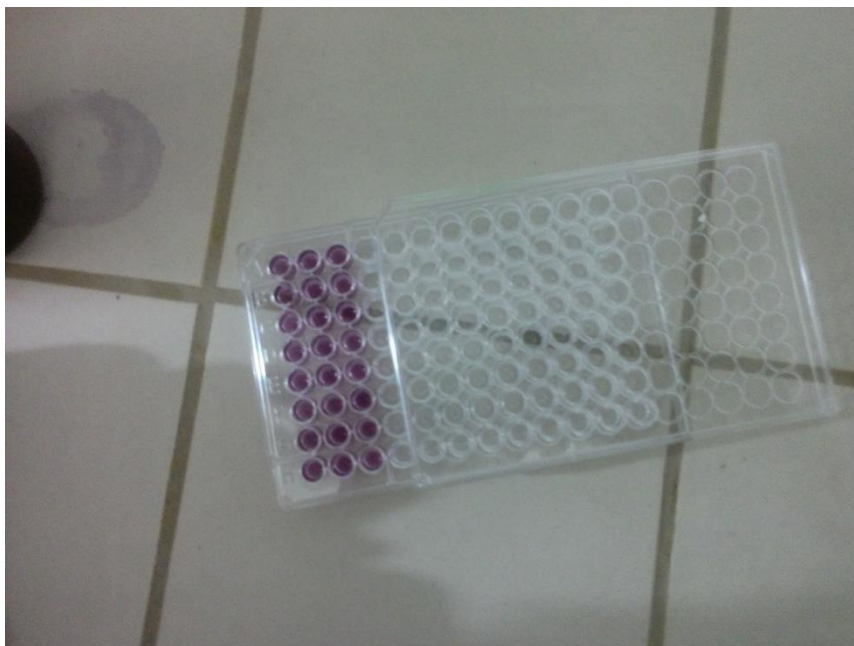
Figure 05: Le résultat du test de décoloration radicalaire par le radical stable DPPH.
