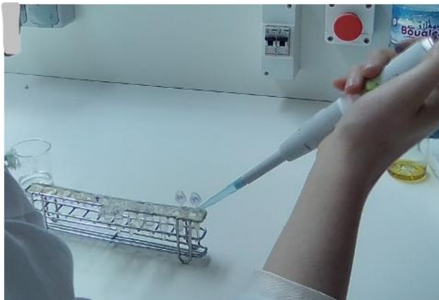
Figure 02: Préparation des dilutions à partir d'une solution mère 4mg/1ml de MeOH jusqu'à 1/6.
