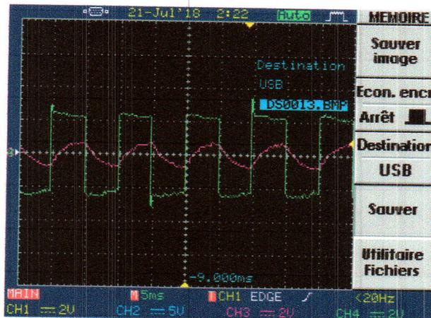
Fig. III-23. Courant et tension obtenus pour deux valeurs de la résistance  $R=52\Omega$ .
