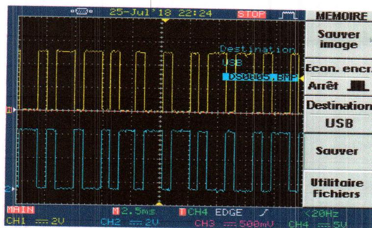
Fig. III-29. Signaux de commande à la sortie de la carte Arduino.
