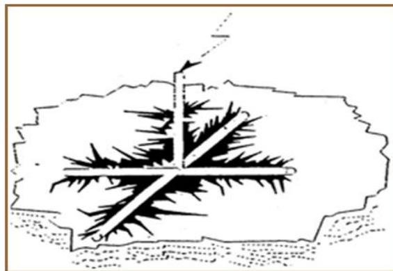
**Figure II.22.** Ionisation du sol sous l'effet des fortes amplitudes du courant.
