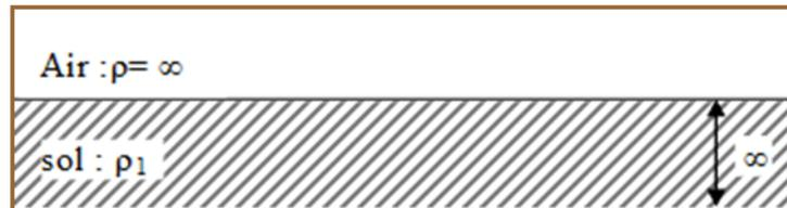
Figure I.14. Sol homogène.
