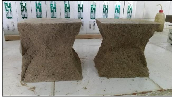
**Figure III.3 :** résultat d’essai de compression.
