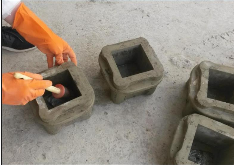
**Figure II.11:** Préparation des moules avant le remplissage.
