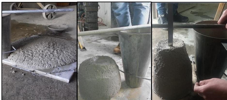
**Figure III.1** : Résultats d'essai d'affaissement.
