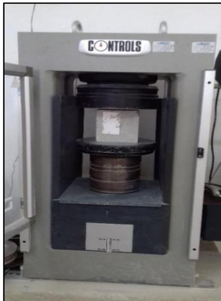
**Figure III.2** : Essai de résistance à la compression
