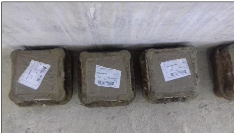
**Figure II.10:** Forme d'éprouvettes d'étude.
