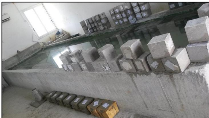
**Figure II.12 :** conservation des éprouvettes.
