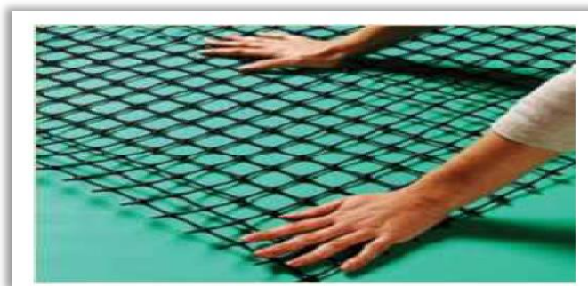
FigureII.21 : Exemple de géogrillebi-axiale.
