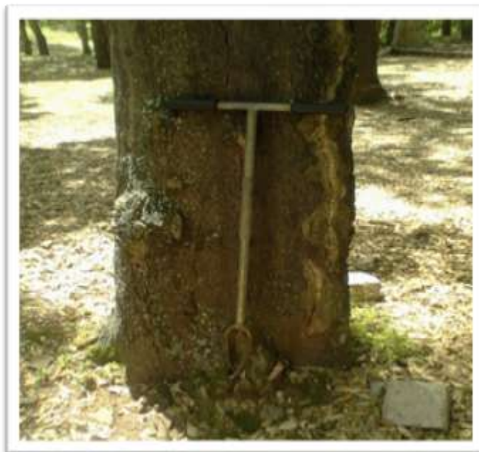
Photo09 : La tarière pour le prélèvement des échantillons de sol.
