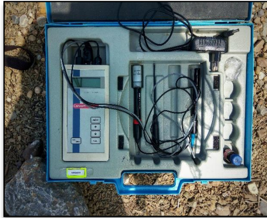
Figure 8. Multiparamètres portable de Type (Consort C561) du laboratoire d'écologie
