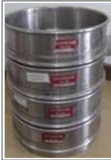
Figure (III, 04): Analyse granulométrie par voie humide.
