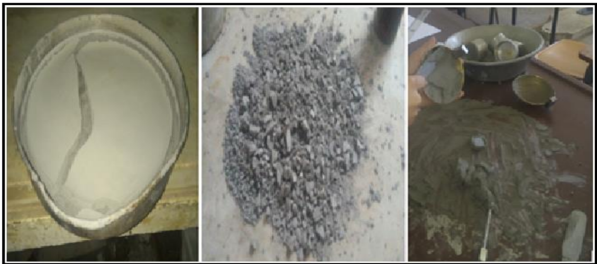
Figure (III, 03): Etapes de l'essai avec l'appareille de Casagrande.
