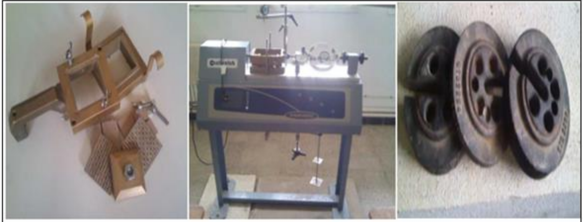
Figure (III, 10): Matériel Essai de cisaillement a la boite.
