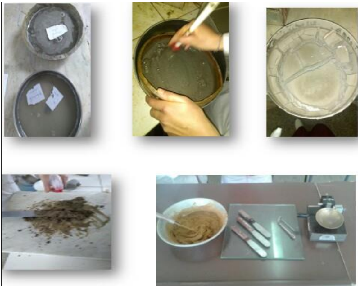
Figure (III, 12): étapes de l'essai avec l'appareille de Casagrande.
