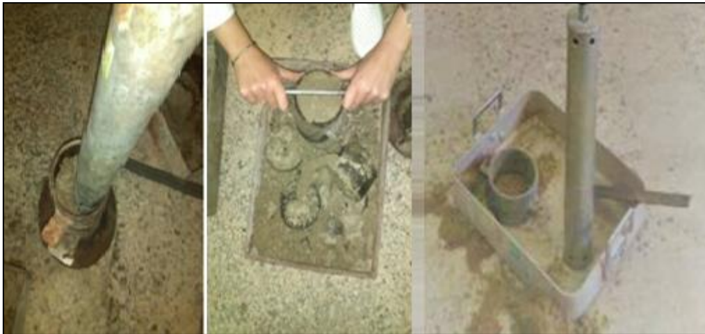
Figure (III, 14): Mode opératoire de l'essai Proctor.
