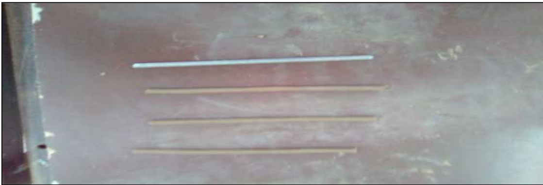
Figure (III, 13): Détermination de la limite de plasticité.
