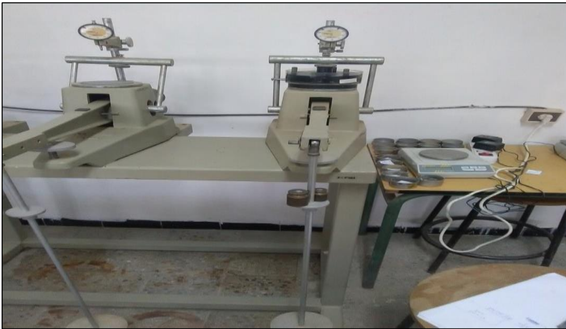
Figure (III, 17): Appareille d'oedométrique.
