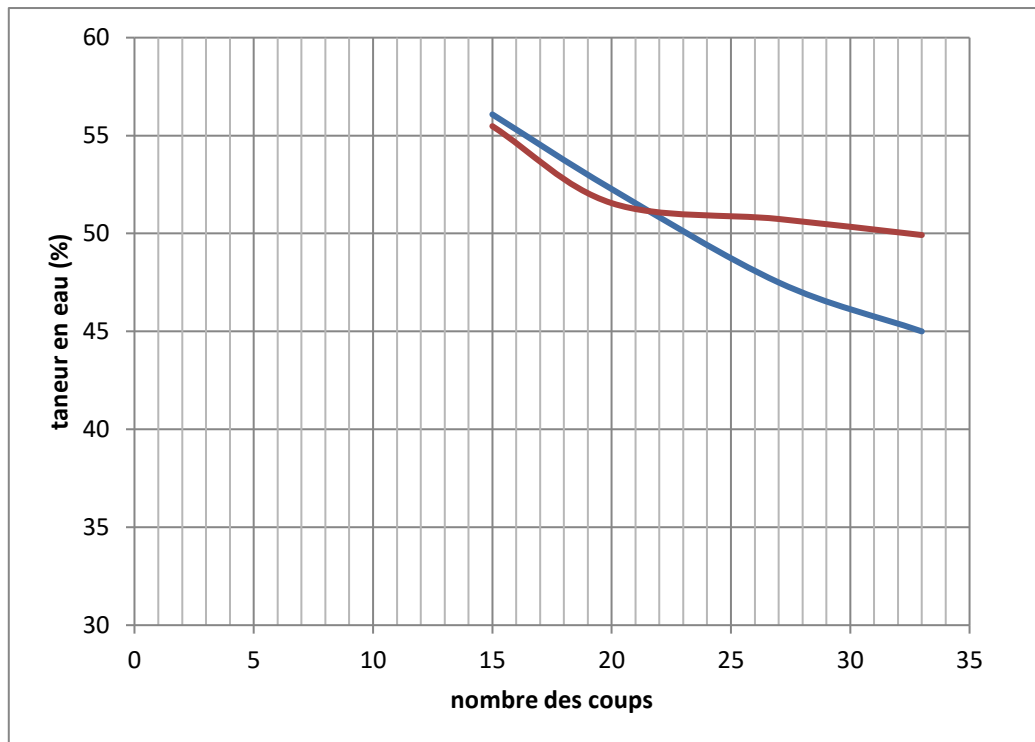
Figure (IV, 02): courbe de la limite de liquidité (schiste).
