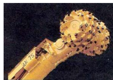
Figure.1.3.b : Bras à attaque radiale
