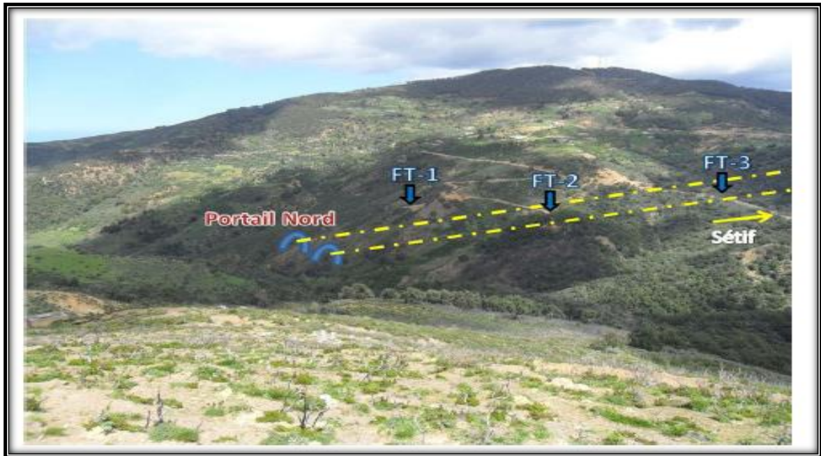
Figure 2.8: Versant nord avec situation du tunnel et des forages réalisés
