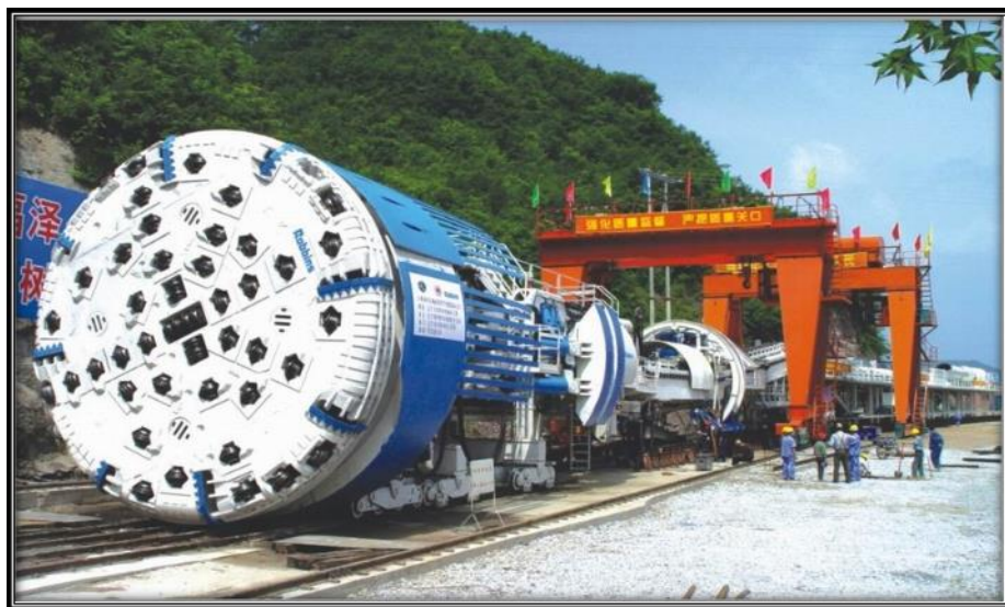
Figure. 1.4 : Machines à attaque global(TBM)
