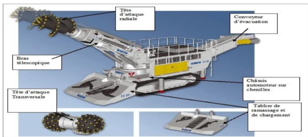
Figure. 1.2 : Machine à attaque ponctuelle
