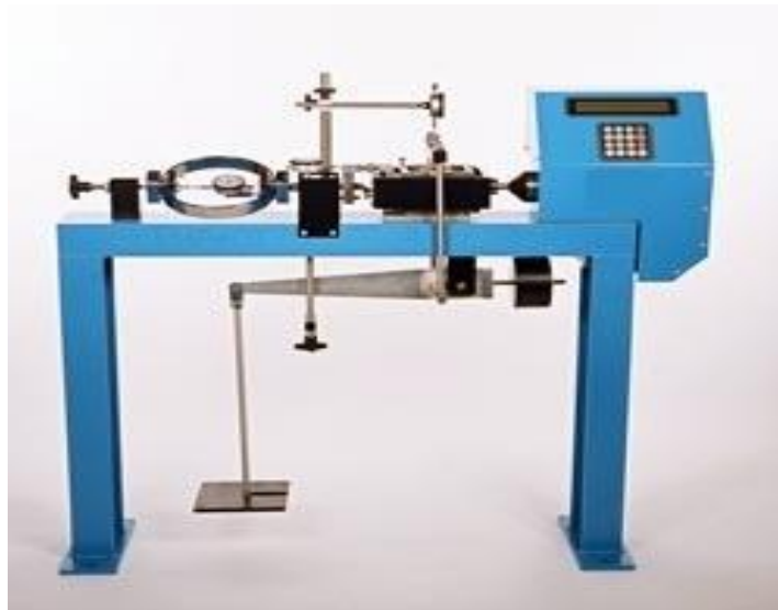
Figure II.15 : Cisaillement rectiligne à la boîte.
