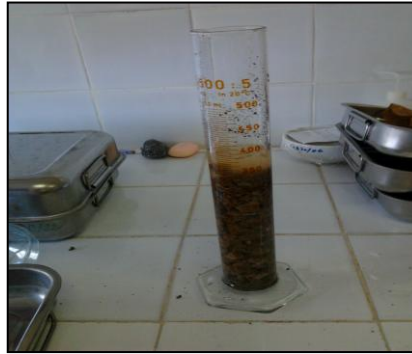
Figure II.14 : Détermination du poids volumique sec.
