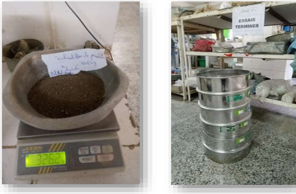
Figure III.4 : Granulométrie par tamisage.
