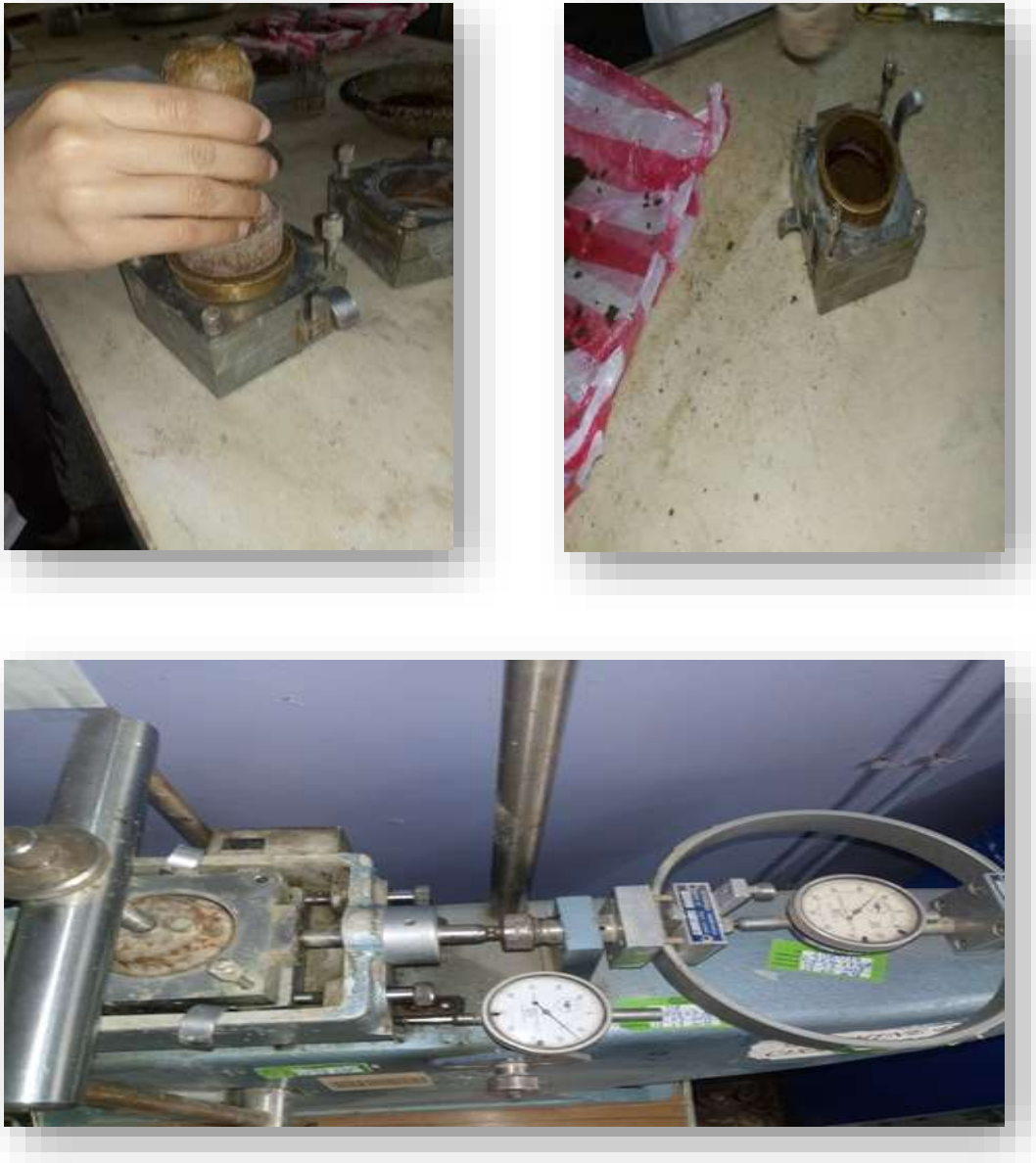
Figure III.13 : Mode d'opérateur de l'essai de cisaillement directe.
