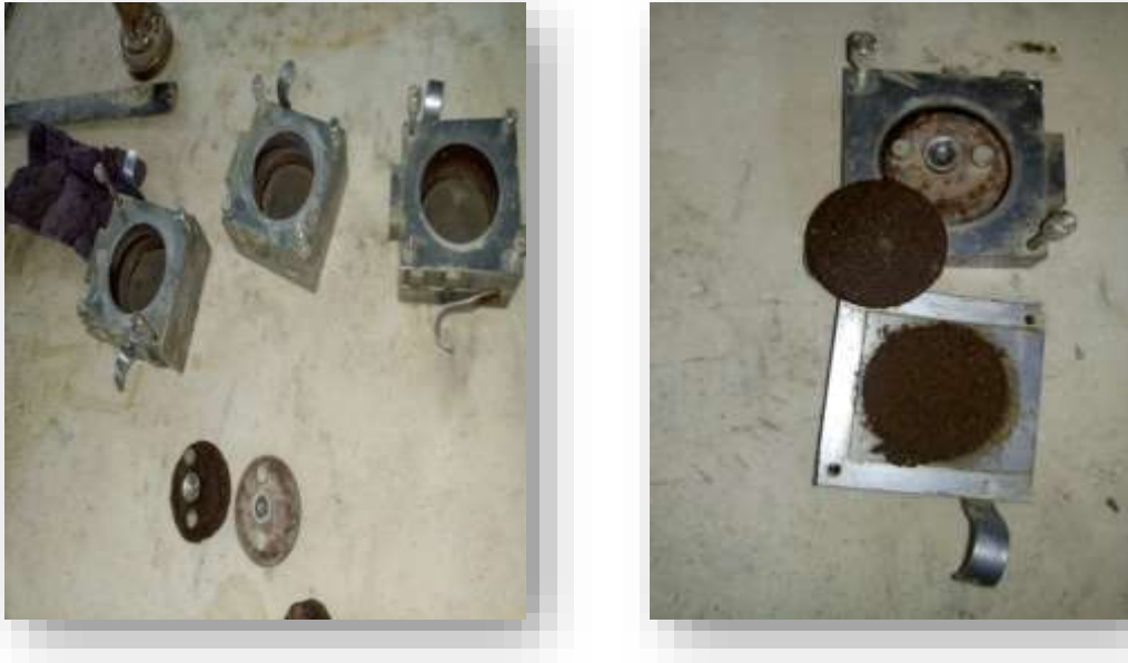
Figure III.12 : Les constituants de la boîte de cisaillement.
